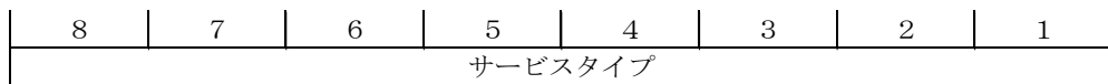
図3-81-7. 36B/NTT-Q763-1 従属パラメータがサービスタイプの場合の内容部フィールド
